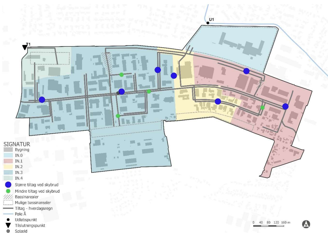
Figur 9: Vurderet omfang af tiltag for skybrudssikring i Rønnevang Erhvervsområde hvor sammenfald med løsninger for separeringen af fællessystemet. Omfang og placering af skybrudstiltag skal kvalificeres i den senere projektudvikling. Stor udgave af kortet kan ses i Bilag A.
