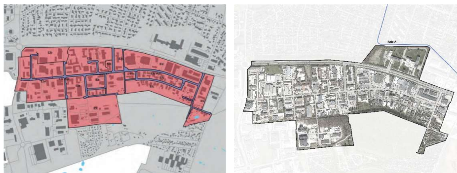
Figur 1 (tv): Indsatsområde for separering af fællessystemet i Rønnevang Erhvervsområde. Figuren viser kloakoplande, som i Spildevandsplan 2018-2021, er udpeget til fraseparering af regnvand fra veje, pladser og kommunale ejendomme indenfor den nuværende planperiode. Status/plan - Fællessystem er markeret med rødt mens plan - Separering er markeret med blå. Figur 2 (th): Afgrænsning af projektområdet.
